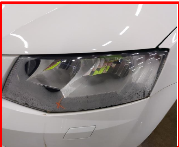
Immigt strålkastarglas är ett tecken på sprucken eller skadad strålkastare.
