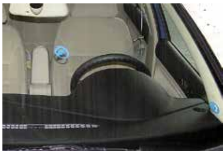
■ 03 Skador eller annan deformation inom synfältet.
